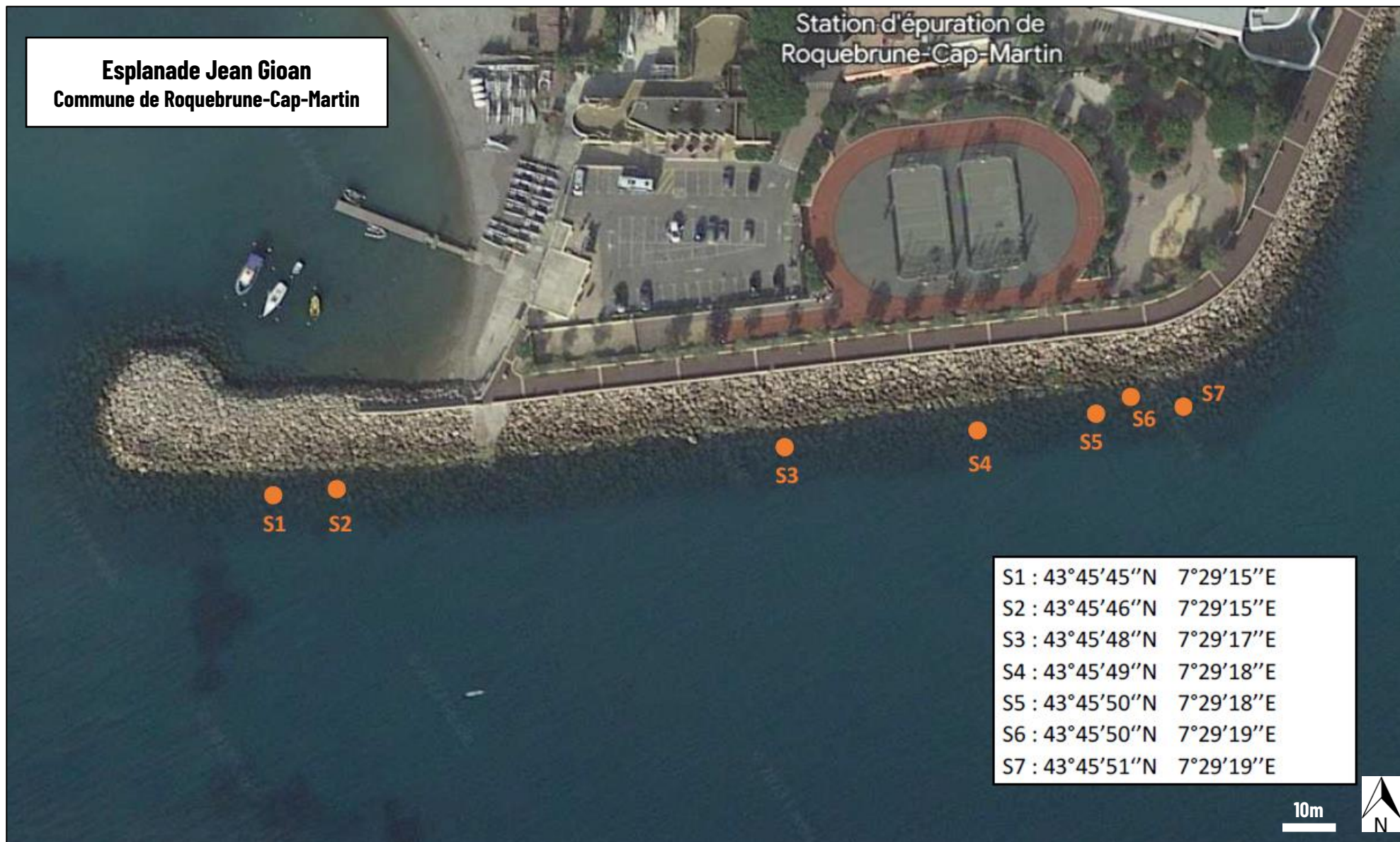
Localisation des protections maritimes concernées par les reprises ponctuelles - Esplanade Jean Gioan (Roquebrune-Cap-Martin)
